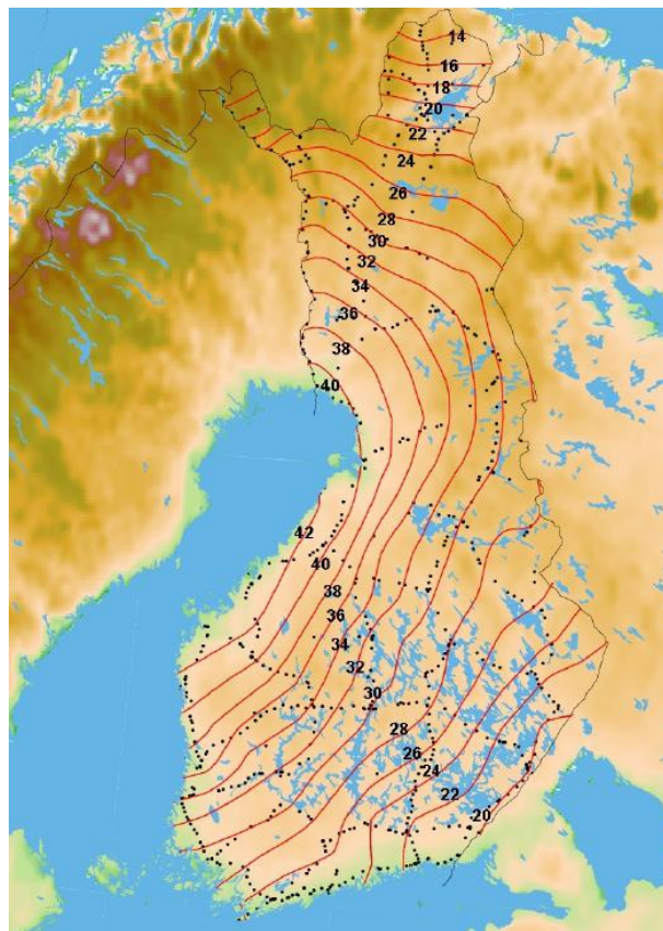
N2000- ja N60- korkeusjärjestelmien erot (cm) 2009. Lähde: Geodeettinen laitos
